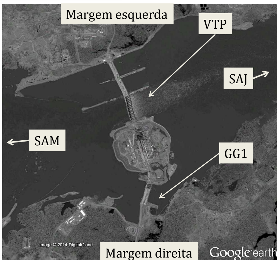
Figura 32. Imagem de satélite de 04/01/2014 da usina hidrelétrica de Santo Antônio (UHESA). Fonte: Google Earth. SAM: Ponto amostral localizado à montante do empreendimento; SAJ: Ponto amostral localizado à jusante do empreendimento; GG1: Grupo Gerador1 localizado na margem direita do rio Madeira; VTP: Vertedouro principal, localizado entre o centro e a margem esquerda do rio Madeira.
