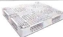
Pallet Plástico PD 1113 com Deslizadores Plásticos Dimensões: 150x1100x1300 mm Carga recomendada: 5.000Kg estática / 1.500Kg dinâmica / ate 700 kg rack porta- pallet.
