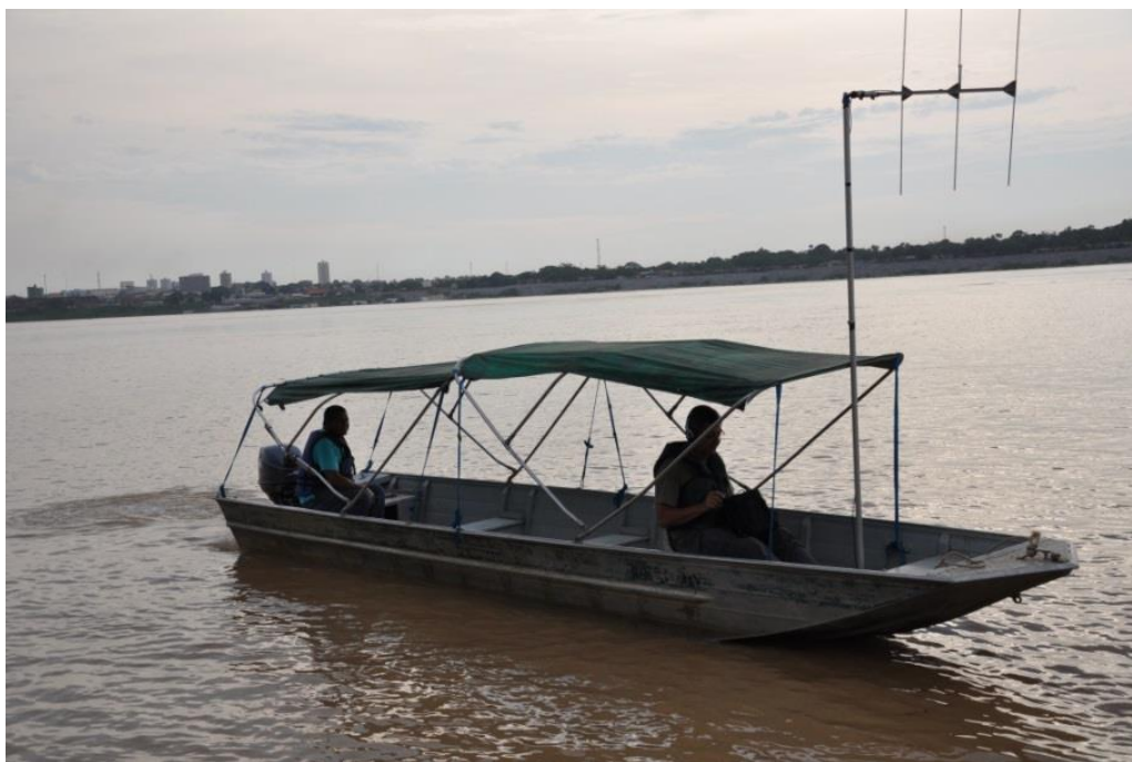
Figura 9: Monitoramento móvel de peixes marcados com radiotransmissores a jusante da UHE Santo Antônio.
