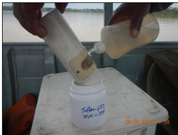
Figura 6. Exemplificação da retirada da amostra retida no copo coletor da rede de ictioplâncton.
