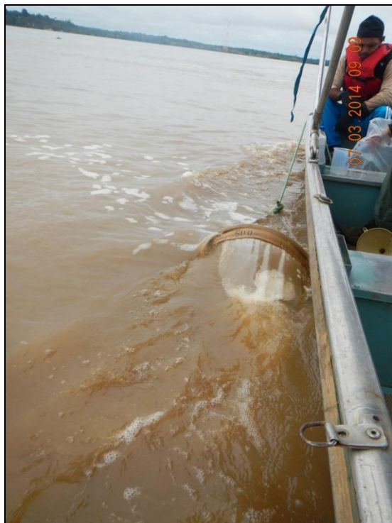
Figura 3. Demonstração do momento de coleta com rede de ictioplâncton posicionada em sentido contrário ao fluxo da água.
