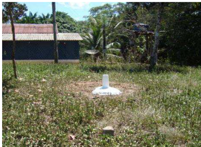
Figura 2.5. Exemplo do Marco Implantado pela PCE na Seção ST 129,8
