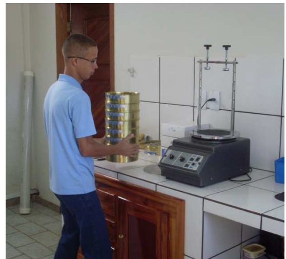
Figura 4.3. Secagem e Peneiramento (agitação mecânica) das Amostras de Material do Leito
