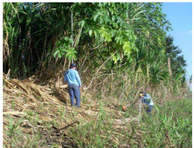
Figura 2.2. Nivelamento das Margens entre o Marco de Referência e o Nível d'Água
