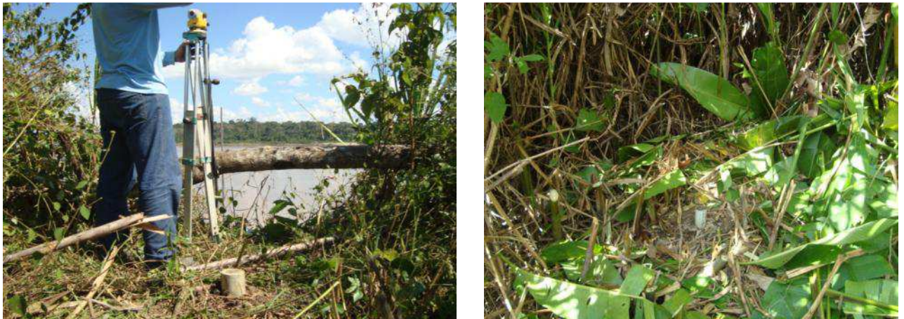
Figura 2.5. Exemplo do Marco Implantado pela PCE na Seção ST 129,8
