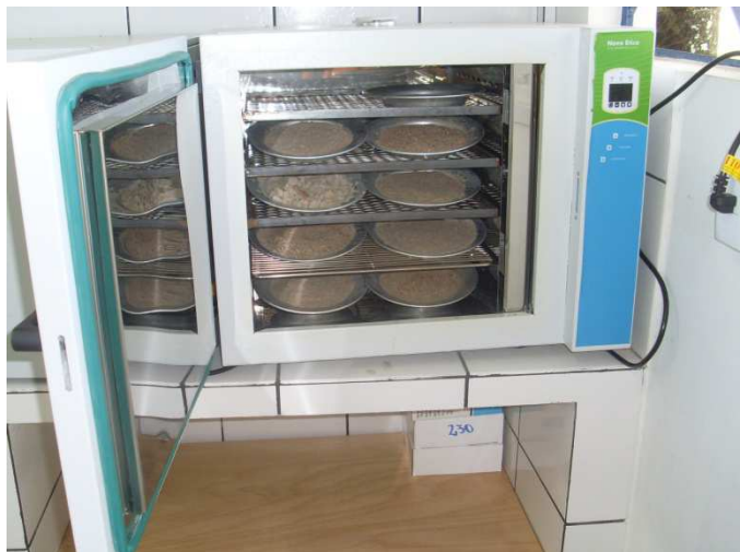
Figura 4.3. Secagem e Peneiramento (agitação mecânica) das Amostras de Material do Leito
