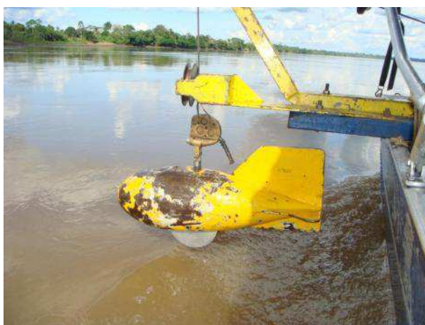
Figura 4.4. Amostrador de Sedimentos do Leito Modelo US BM-54
