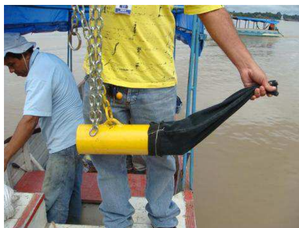
Figura 4.5. Amostrador de Sedimentos do Leito do Tipo de Raspagem Horizontal
