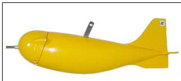
Figura 4.2. Amostrador de Sedimento em Suspensão - Modelo D-49
