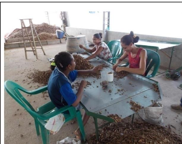
**Figura 15:** Separação manual das amêndoas e endocarpo quebrados em parte iguais.
