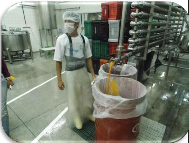
**Figura 63 – Saída da polpa do pasteurizador.**
