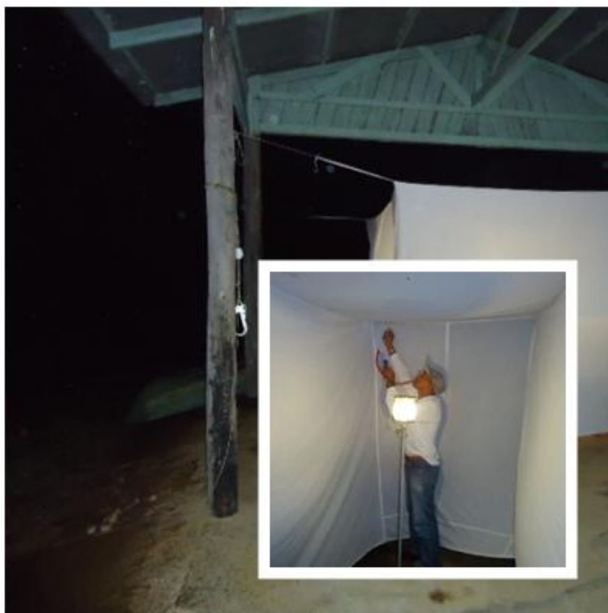
Figura 2. Armadilha Shannon , com atração luminosa, utilizada para a captura de triatomíneos nas áreas de influência da UHE Santo Antônio, Porto Velho – RO, setembro/outubro 2013.
