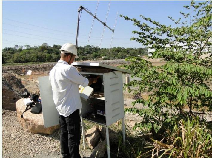
Figura 1. Downloading de dados armazenados em bases fixas.
