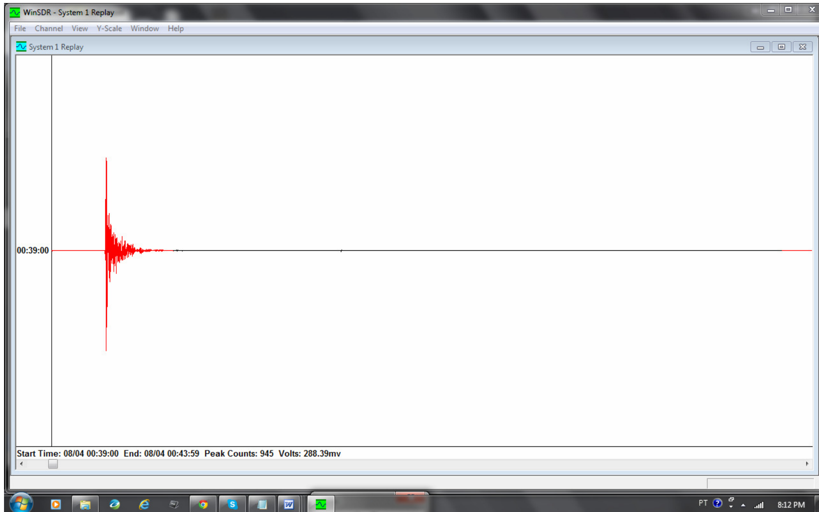
Sismograma filtrado do dia 04 de Agosto (bandpass entre 0.1 e 2 Hz). Nota-se o evento principal, às 00:39 GMT.
