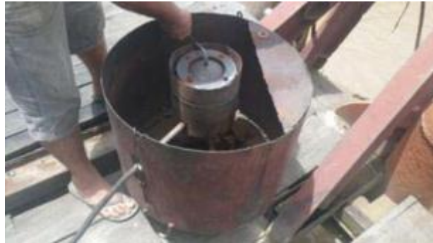
FIGURA 8: Retorta utilizada no processo de recuperação do mercúrio na separação do ouro do amálgama.
