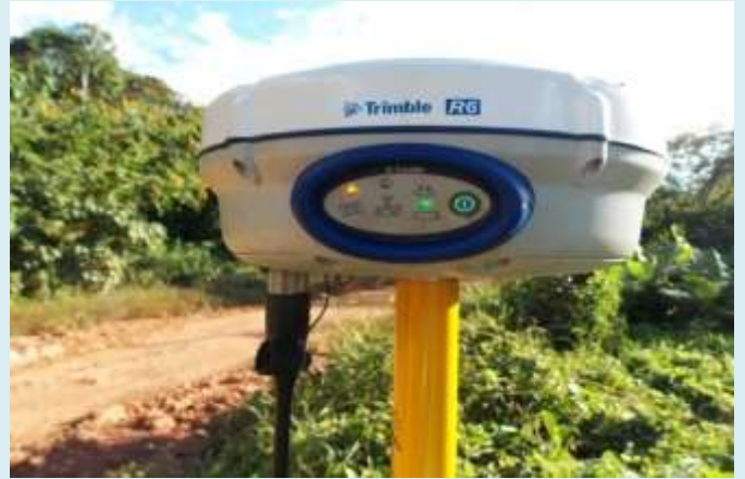
Equipamento(Rouger) onde são armazenados os dados do georeferenciamento.
