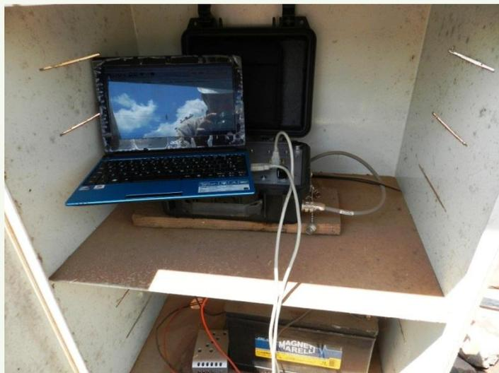
Figura 2. Downloading de dados armazenados por bases fixas do STP.
