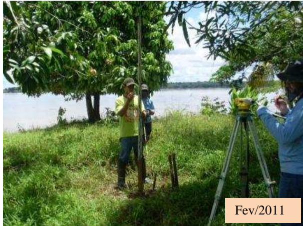
Figura 3.17. Implantação do Piquete e do Marco de Referência no Local de Monitoramento 3
