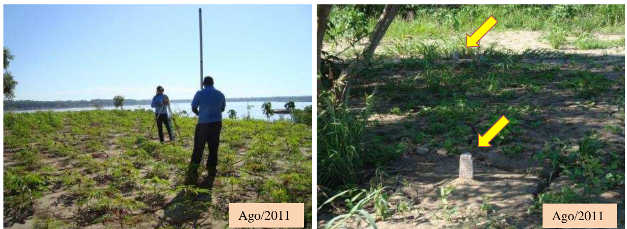
Figura 3.53. Levantamento do Perfil e Localização dos Marcos de Referência no Local de Monitoramento 12 durante o Levantamento de Agosto/2011
