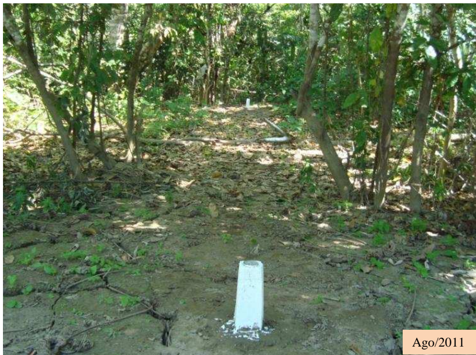
Figura 3.76. Alinhamento dos Marcos de Referência no Local de Monitoramento 16 durante o Levantamento de Agosto/2011
