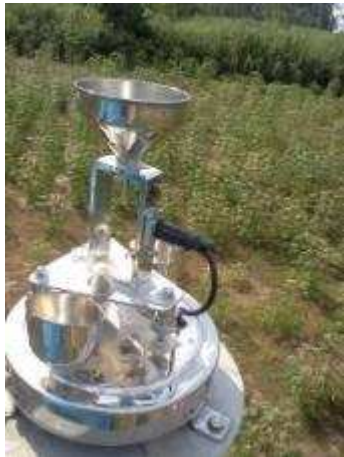
Limpeza do pluviômetro
