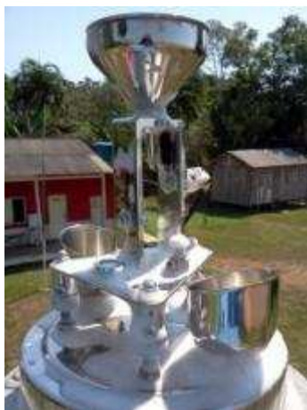
Limpeza do pluviômetro
