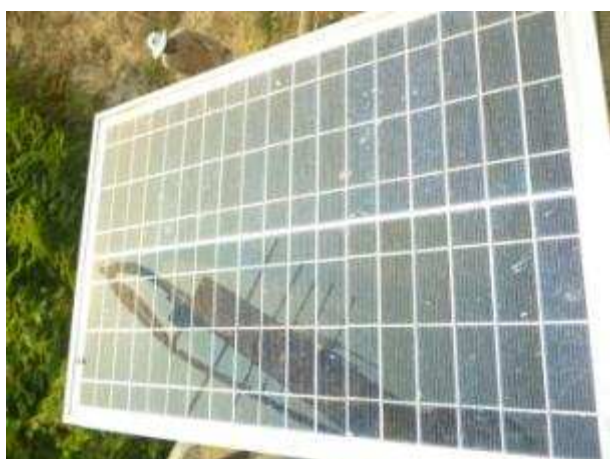
Placa solar suja
