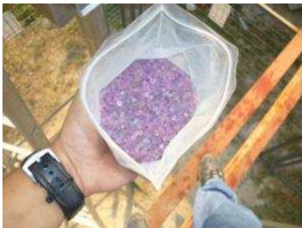
Sílica a ser substituída
