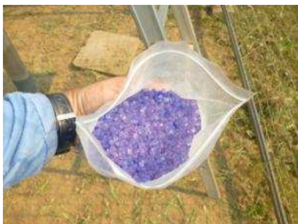
Sílica a ser substituída
