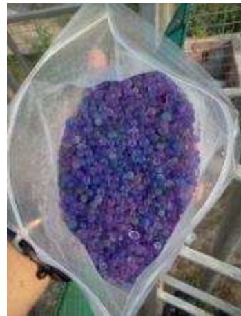
Sílica a ser substituída
