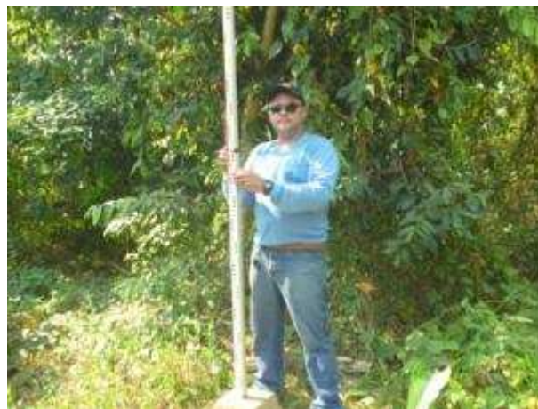
Nivelamento da estação
