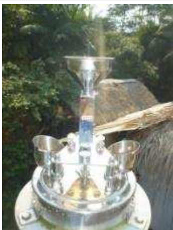
Limpeza do pluviômetro
