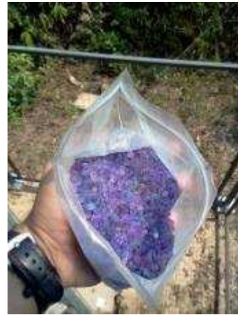
Sílica a ser substituída
