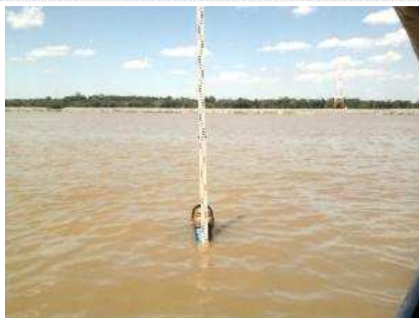
Nivelamento da régua 4-6 m.
