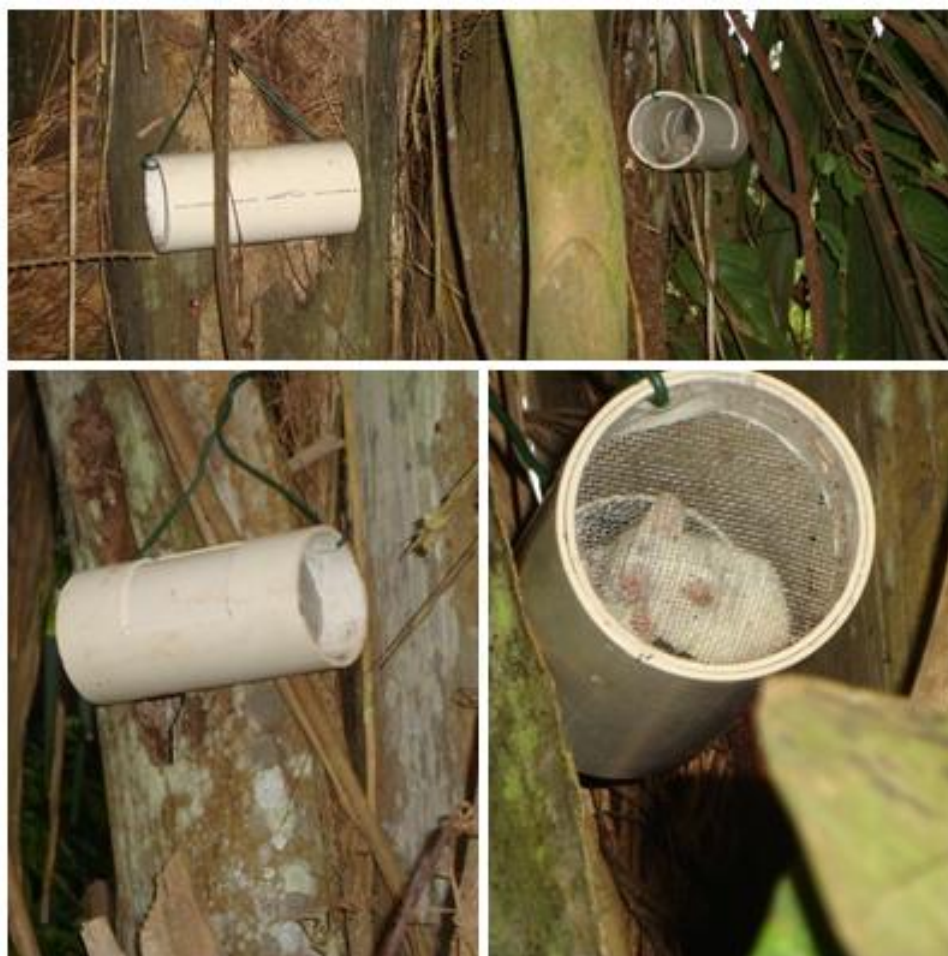
Figura 1. Armadilha de PVC (com atração de isca animal), para captura de triatomíneos, utilizada nas no âmbito do Programa de Monitoramento de Vetores nas áreas de influência da UHE Santo Antônio, Porto Velho – RO.
