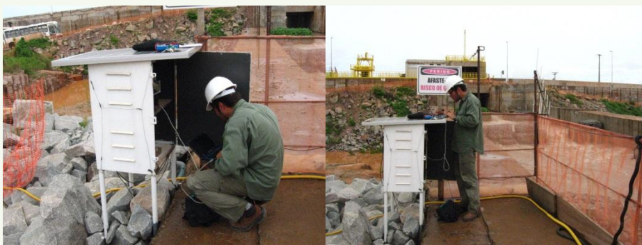
Figura 5. Downloading de dados armazenados por bases fixas do STP.
