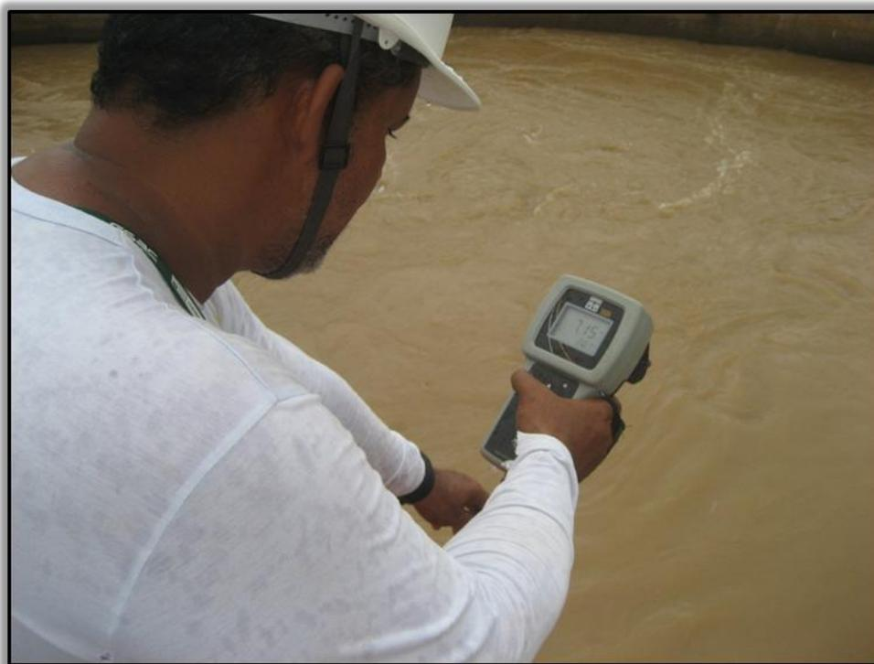
**Figura 08.** Medição de oxigênio dissolvido (mg/l) e temperatura (°C) no STP da ilha do Presídio em dezembro de 2012 – Usina Hidrelétrica Santo Antônio, rio Madeira, Porto Velho/RO.
