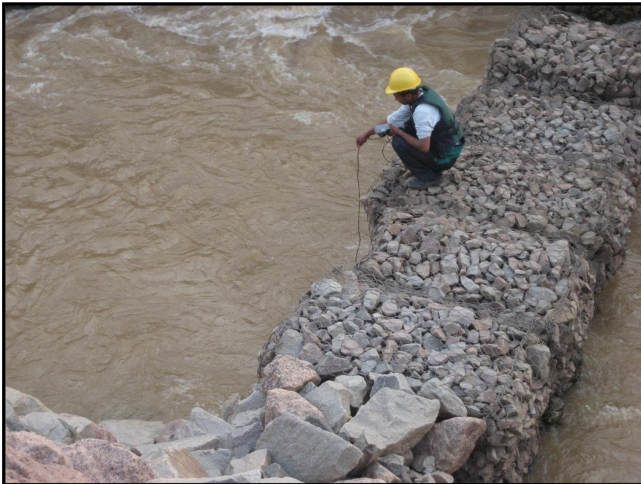
Figura 06. Medição de oxigênio dissolvido (mg/l) e temperatura (°C) no STP da ilha do Presídio em outubro de 2012 – Usina Hidrelétrica Santo Antônio, rio Madeira, Porto Velho/RO.
