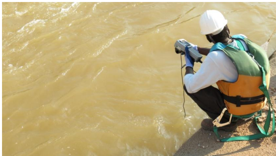
Figura 09. Medição de oxigênio dissolvido (mg/l) e temperatura (°C) no STP da ilha do Presídio em setembro de 2012 – Usina Hidrelétrica Santo Antônio, rio Madeira, Porto Velho/RO.
