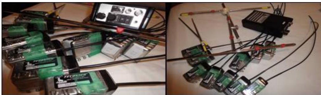
Figura 4. Equipamentos de telemetria (rádios-transmissores, receptor TR4 e antena) importados da Empresa Telonics, USA.
