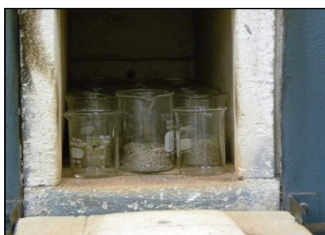
Figura VIII.8. Calcinação das macrófitas em forno mufla.
