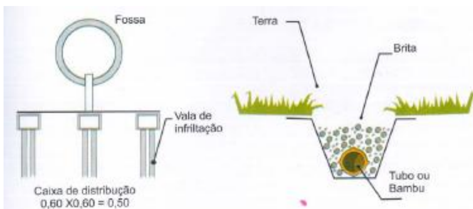
Figura 9 – Esquema de vala de infiltração
