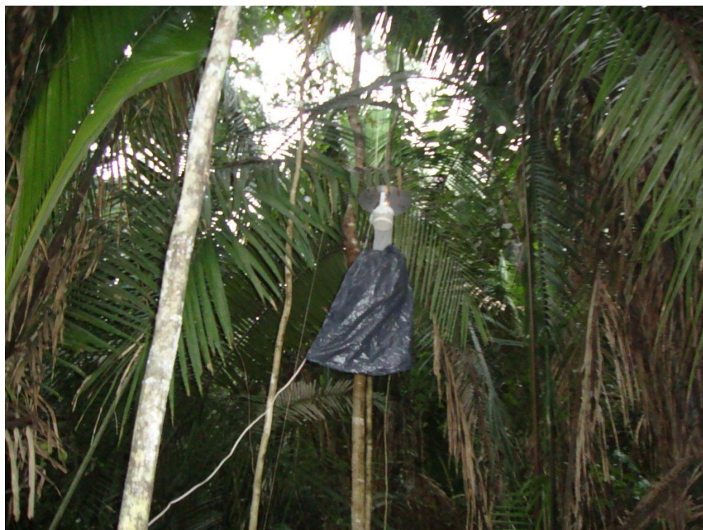
Figura 1. A) Instalação da armadilha luminosa CDC miniature light trap ; B) armadilha luminosa instalada para a captura de flebotomíneos nas áreas de influência da UHE Santo Antônio, Porto Velho – RO.
