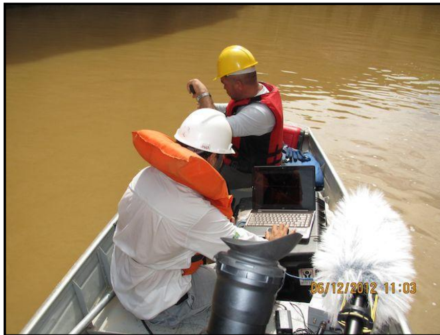
FIGURA 2. Detalhes da utilização de sonar (DIDISON 300m): na parte inferior do STP ilha do Presídio, UHE Santo Antônio, rio Madeira – Porto Velho - Rondônia (junho, 2012).
