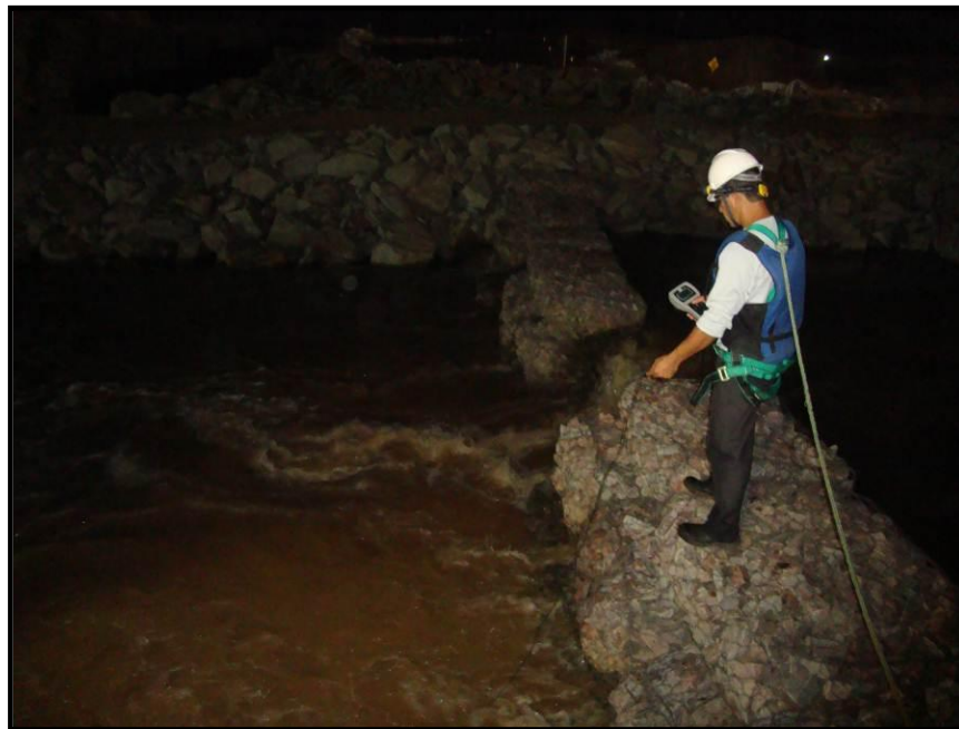
Figura 4. Medição de oxigênio dissolvido na água (mg/l) e temperatura (°C) no STP da ilha do Presídio em junho de 2012 – Usina Hidrelétrica Santo Antônio, rio Madeira - Rondônia.
