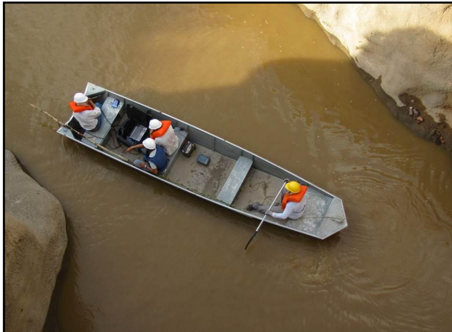
Figura 2. Detalhes da utilização de sonar (DIDISON 300m): próximo ao gabião 55 do STP ilha do Presídio, UHE Santo Antônio, rio Madeira – Porto Velho - Rondônia (maio, 2012).
