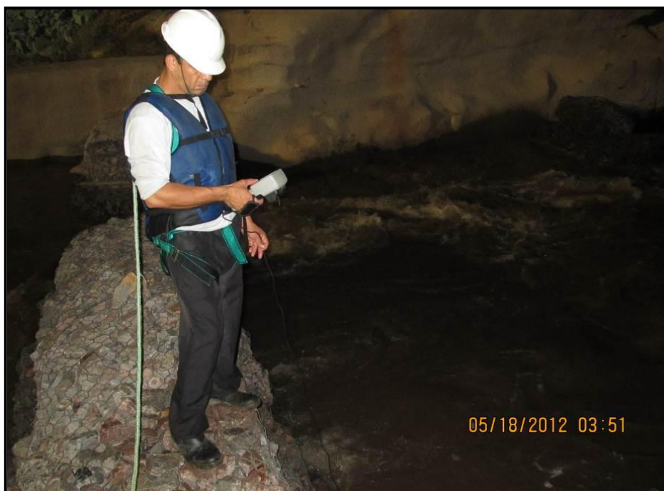
Figura 4. Medição de oxigênio dissolvido (mg/l) e temperatura (°C) no STP da ilha do Presídio em maio de 2012 – Usina Hidrelétrica Santo Antônio, rio Madeira - Rondônia.
