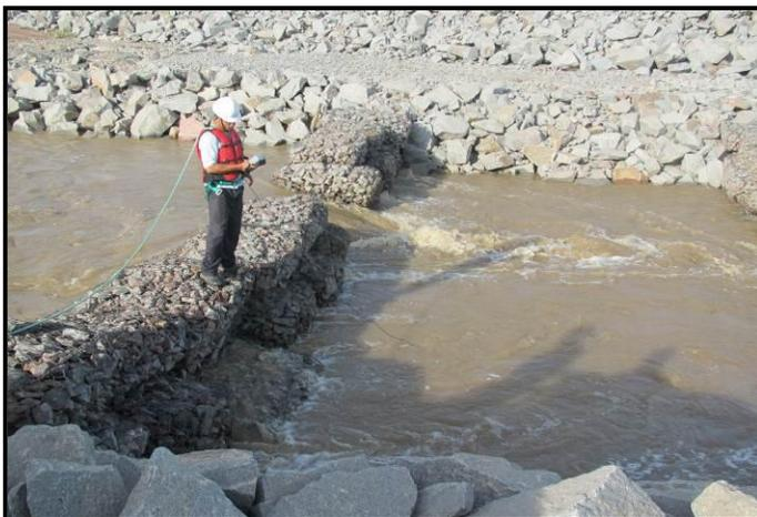
**FIGURA 6.** Medição de oxigênio dissolvido (mg/l) e temperatura (°C) no Sistema de Transposição de Peixes da ilha do Presídio em abril de 2012 – Usina Hidrelétrica Santo Antônio, rio Madeira - Rondônia.
