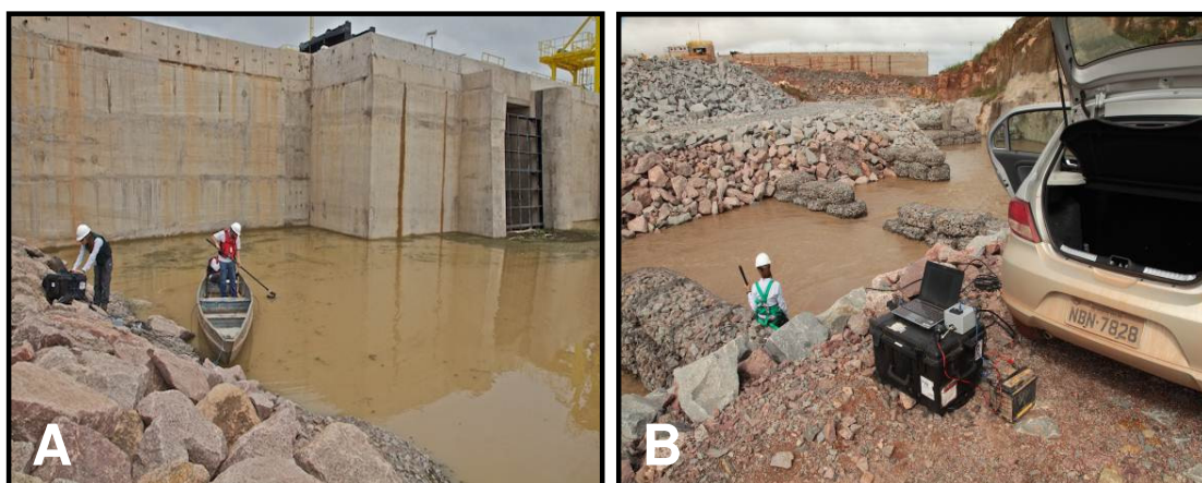
FIGURAS 4 A e B. Detalhes da utilização de sonar (DIDISON 300m): (A) a montante do STP e (B) em “slot” do STP na ilha do Presídio, UHE Santo Antônio, rio Madeira – Porto Velho/RO (março, 2012).
