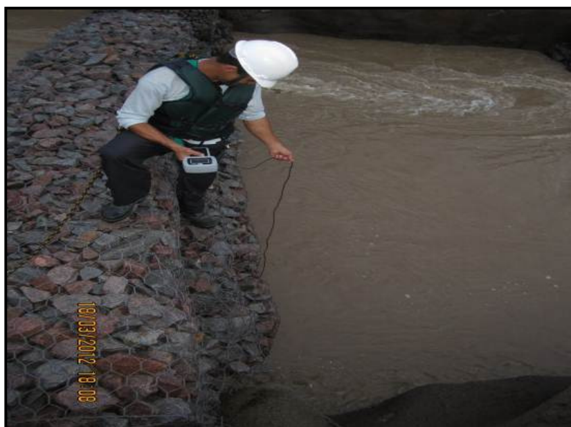
FIGURA 6. (A) Medição de oxigênio dissolvido (mg/l) e temperatura (°C) no STP da ilha do Presídio em março de 2012 – UHE Santo Antônio, rio Madeira/RO.
