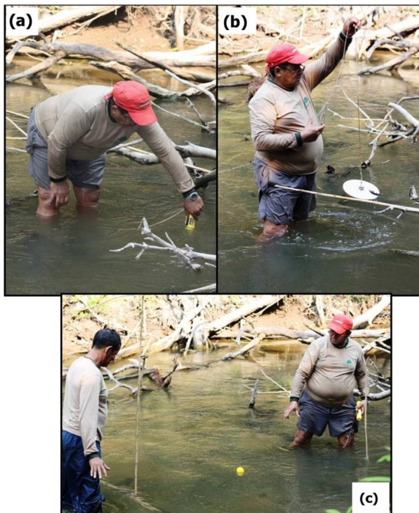
Figura 2. Métodos utilizados para medir (a) profundidade, (b) transparência da água e (c) velocidade da correnteza na frente das tocas e paragens em uso durante os períodos de seca e enchente.
