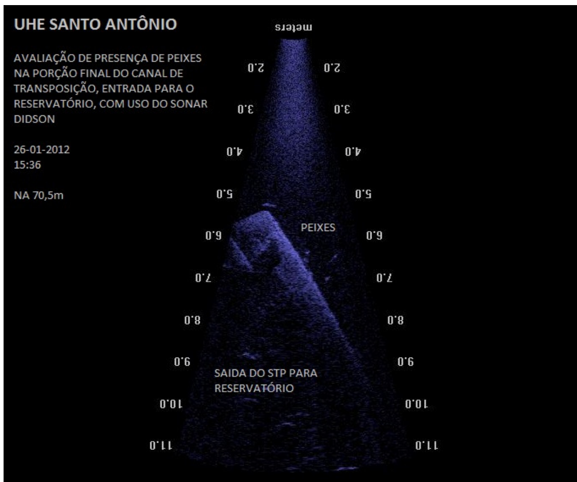
FIGURA 15. 9: Imagem obtida com DIDSON da saída do STP da Ilha do Presídio para o reservatório mostrando peixes deixando a passagem para o corpo do reservatório
