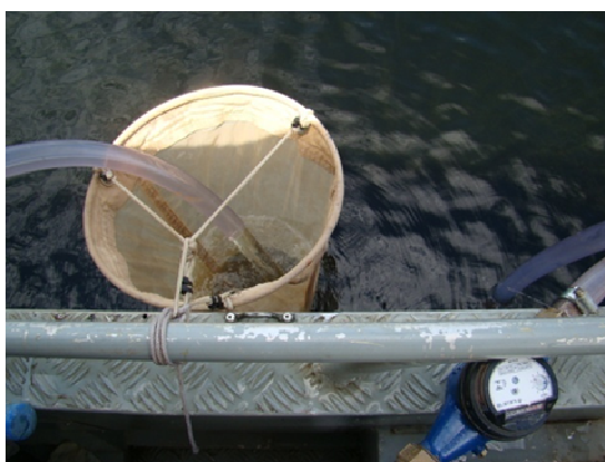
FOTO 10. 3: Procedimento de amostragem de fitoplâncton em profundidade. Filtração de amostra de água bombeada da profundidade no perfil da coluna d'água
