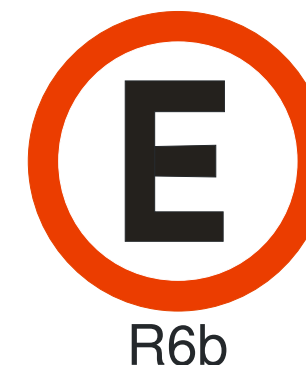
Figura 13. Placa de Regulamentação – Estacionamento Regulamentado (CONTRAN, 2007).
