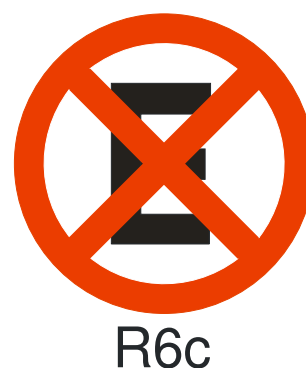
Figura 12. Placa de Regulamentação – Proibido Parar e Estacionar (CONTRAN, 2007).
