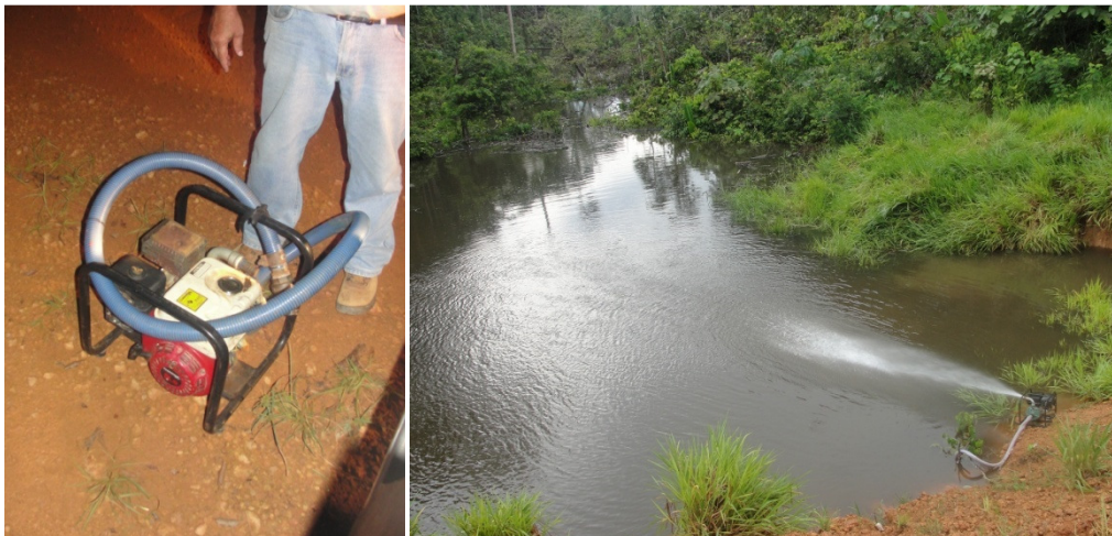
FIGURA 46: À esquerda: bomba utilizada. À direita: bomba em operação, instalada na margem, no igarapé Jatuarana.
