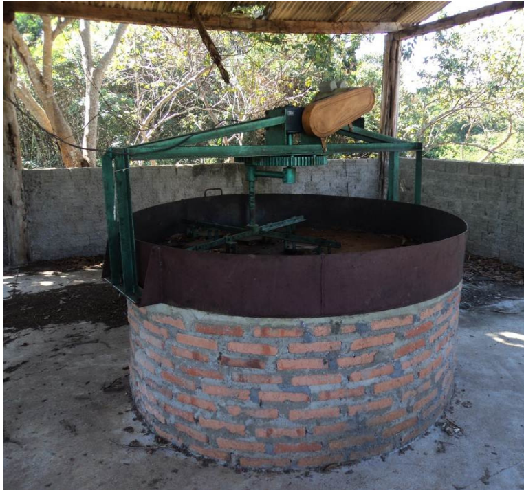
Foto 6-94 Forno com pás elétricas
