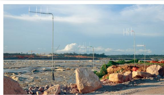
As antenas, que captam as informações dos peixes, são instaladas em pontos fixos na margem do Madeira, ou em barcos, que se deslocam em vários pontos do rio
