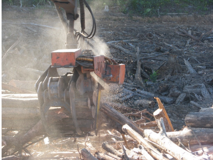
Foto 14 – Cabeçote utilizado para traçamento de lenha em pátios
