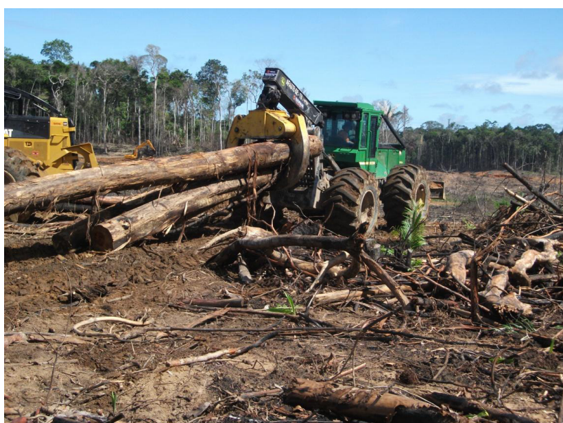
Foto 4 – Arraste de tora com utilização de Skidder.
