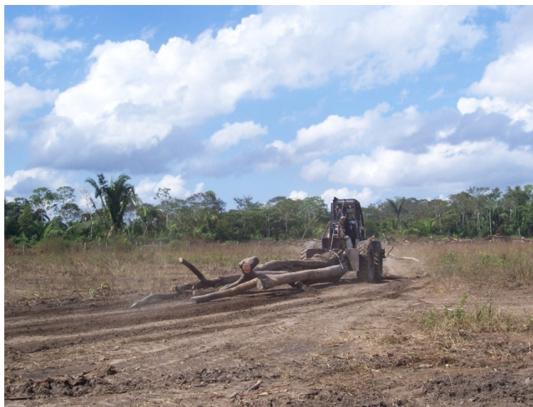
Foto 4 – Arraste de tora com utilização de Skidder.
