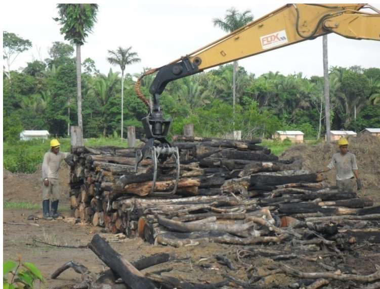
Foto 16 – Empilhamento mecanizado de lenha
