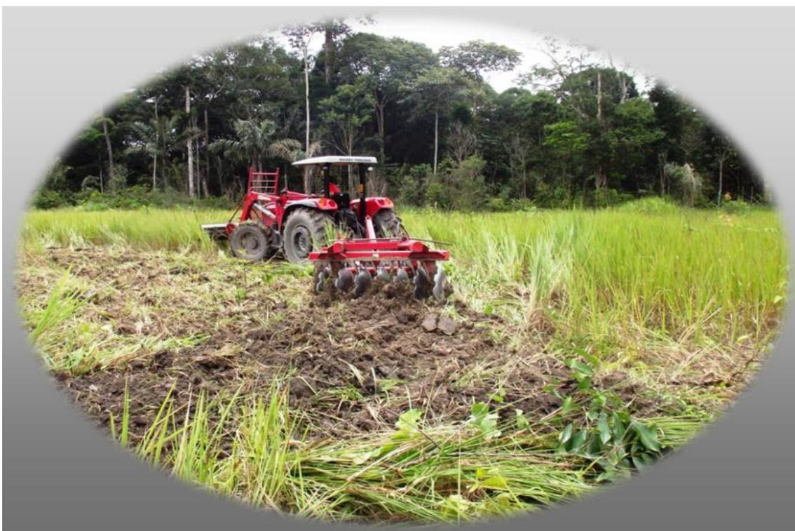
**FOTO 2 – OPERAÇÃO DE GRADAGEM COM TRATOR AGRÍCOLA**
