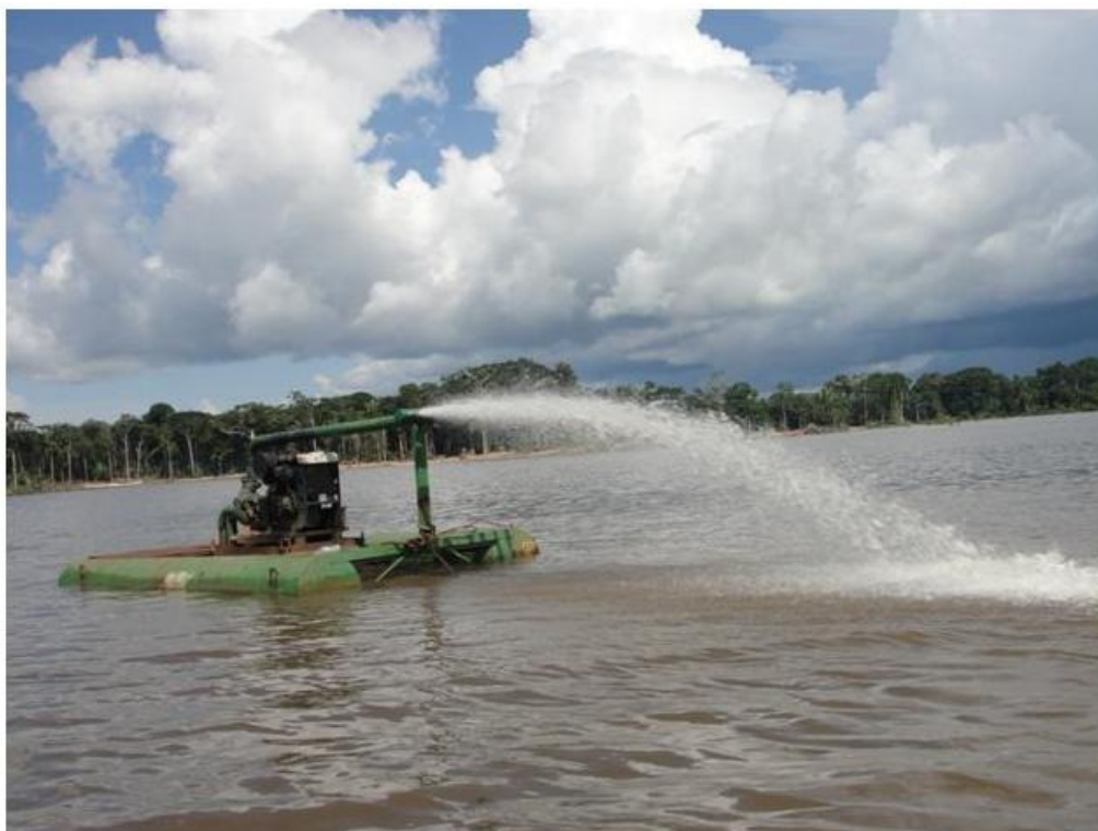
FOTO 2: Bomba 2 sobre balsa instalada para aeração da água – coordenadas UTM 0351770/8994939
