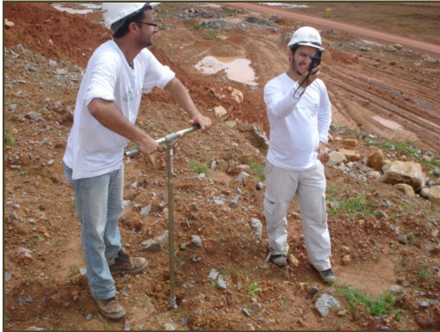
Figura II.1. Coleta das amostras de sedimentos/solos/rochas realizada no canteiro de obras.
