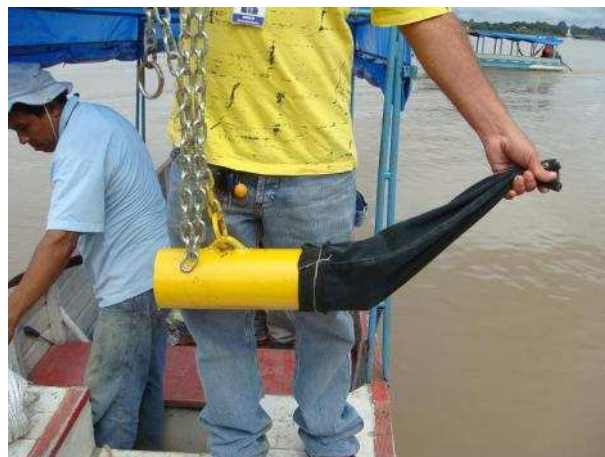
Figura 4.7. Amostrador de Sedimentos do Leito do Tipo de Raspagem Horizontal
