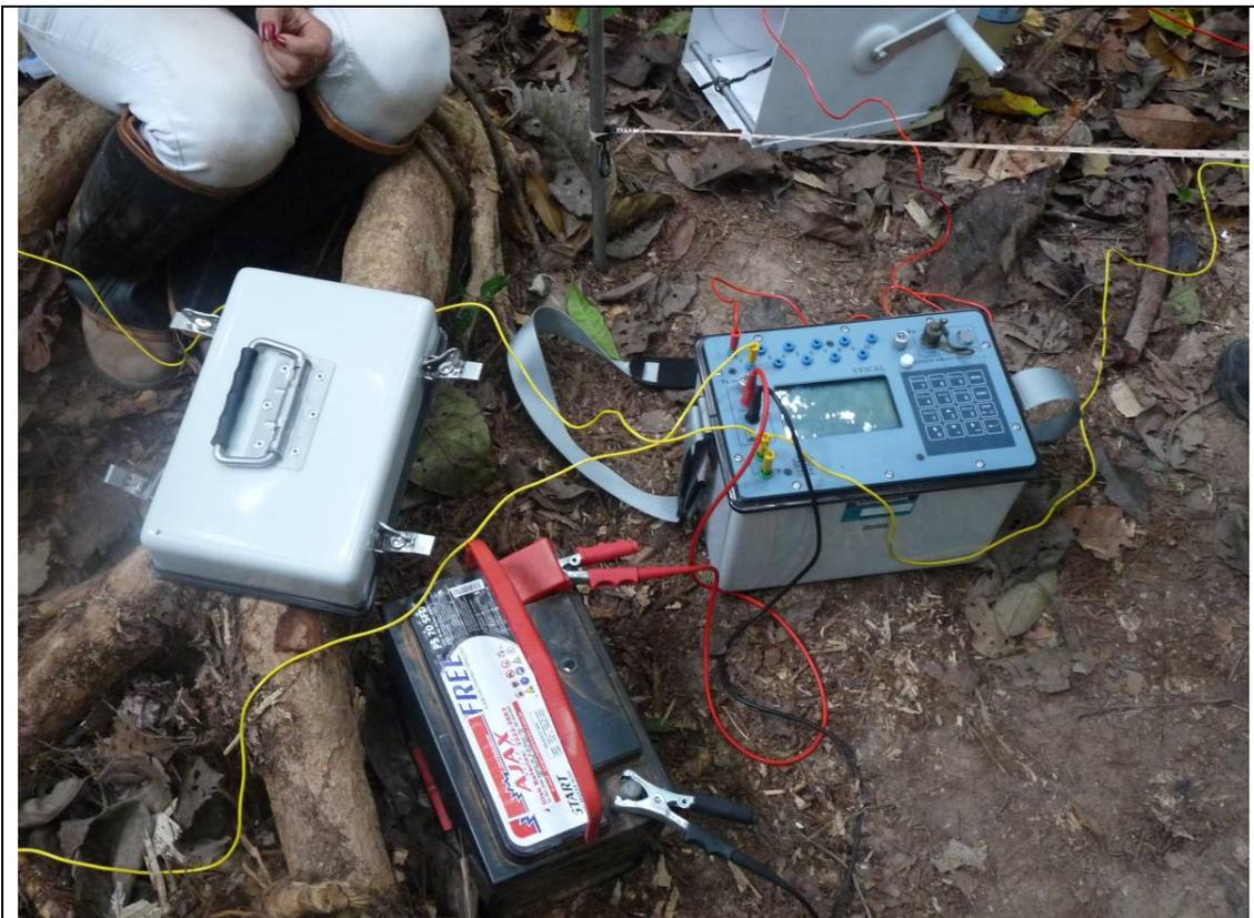
Figura 13. Equipamento utilizado na aplicação do método de geofísica, baseado na eletrorresistividade.
