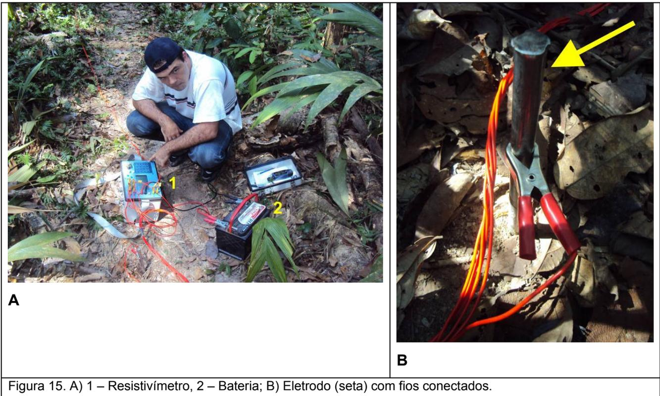
Figura 15. A) 1 – Resistivímetro, 2 – Bateria; B) Eletrodo (seta) com fios conectados.
