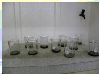
Figura VII.5. Extração química das amostras em chapa quente.
