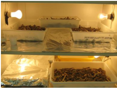
Figura VII.1. Amostras secando em estufa a 40° C.
