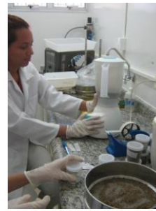
Figura VII.2. Trituração e peneiramento das amostras.
