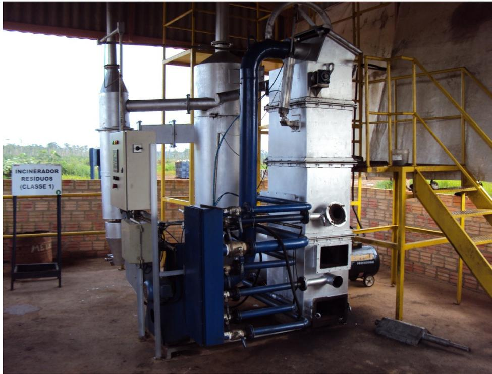
Melhoria no sistema de resfriamento dos gases do incinerador.
