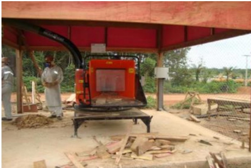
Instalação do Triturador Madeira
