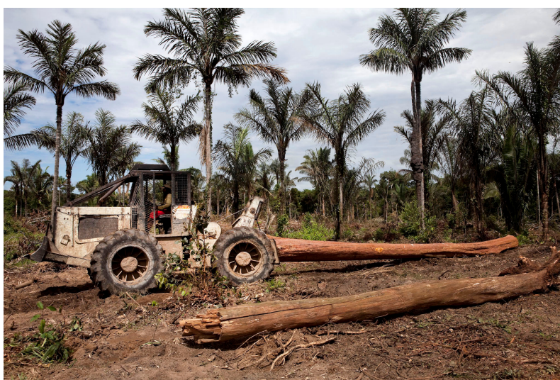
Foto 3 – Arraste de tora com utilização de Skidder
