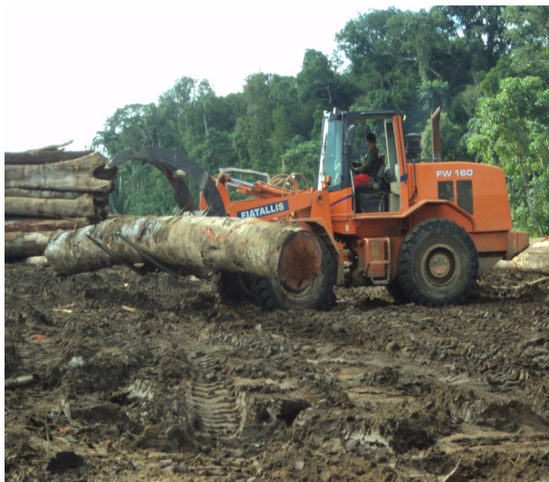
Foto 4 – Movimentação de toras no pátio de estocagem
