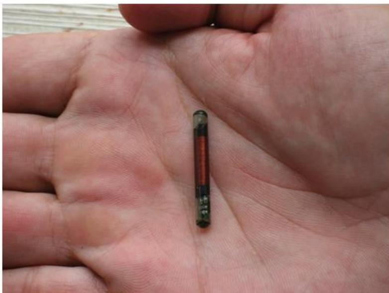
**FIGURA 15. 2:** *Pit Tag* ou *Transpoder* fixado no peixe e que emite sinal ao passar pelo campo eletromagnético das antenas instaladas no canal, e indicando o sentido de deslocamento dos peixes no CET
