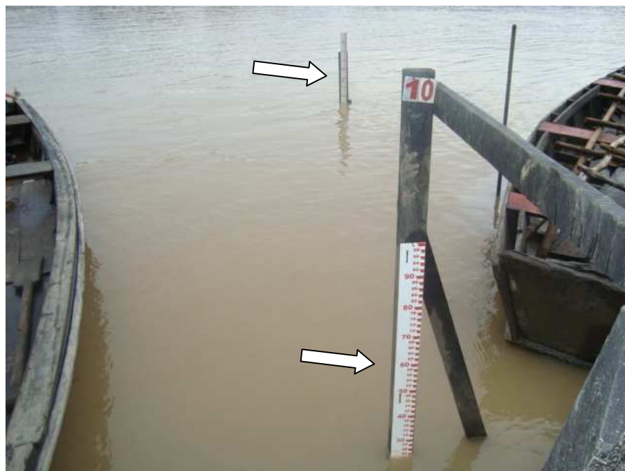
Figura 3.2. Fotografia que ilustra os Lances de Régua Paralelos que Podem ter Induzido ao Erro nas Leituras a partir do dia 30 de Setembro de 2009
