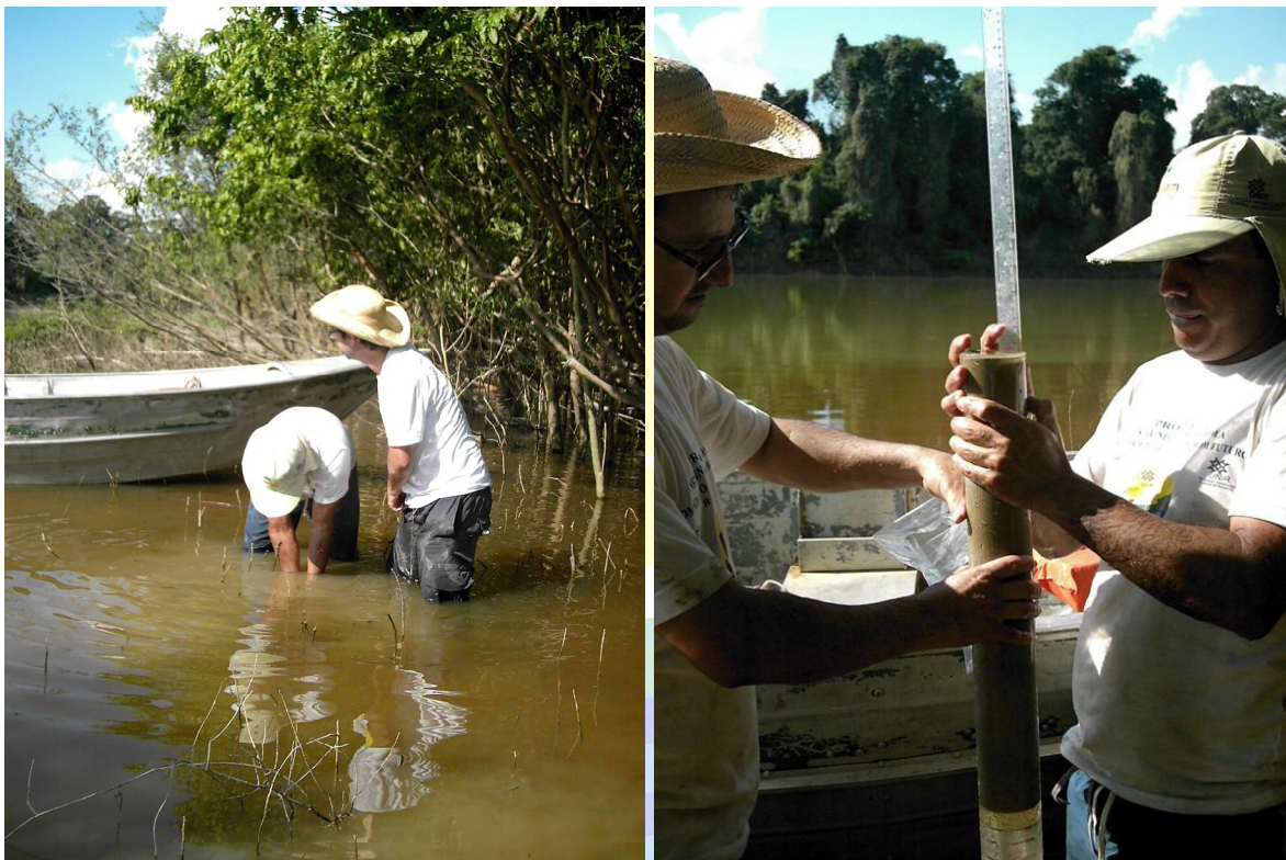
Figuras 6 e 7. Coleta de perfil vertical de sedimento em áreas de deposição natural e fatiamento dos perfis verticais.
