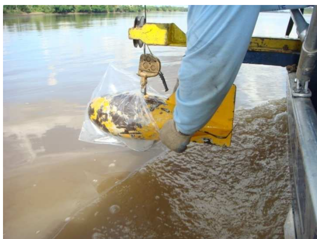
Operação do amostrador de sedimentos de fundo em Abunã
