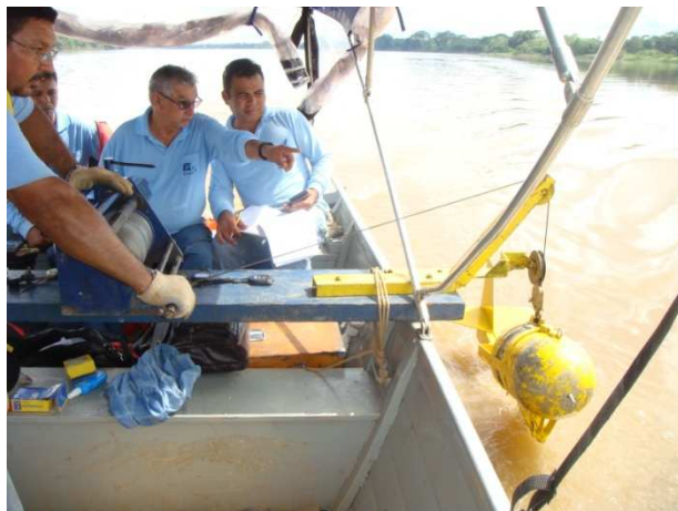
Operação do amostrador de sedimentos em suspensão em Abunã
