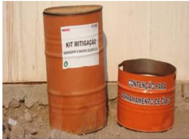
FOTO 6: Kit mitigação contra vazamentos com a utilização de serragem.
