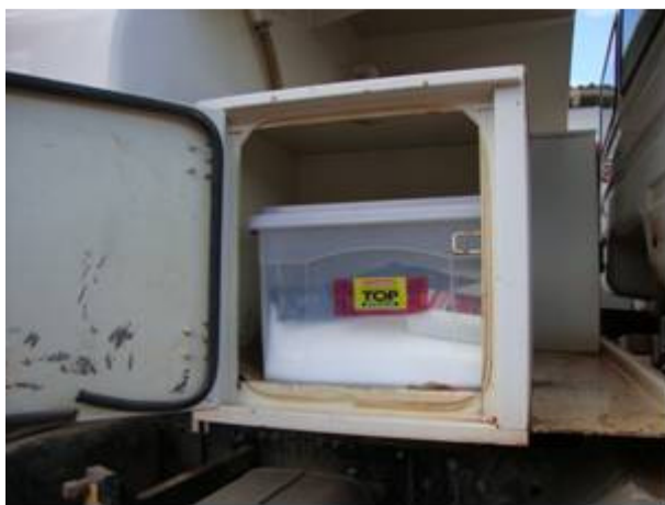
FOTO 5: Kit para contenção de vazamentos de óleo com a utilização de allsobr (produto granulado absorvente de óleo).
